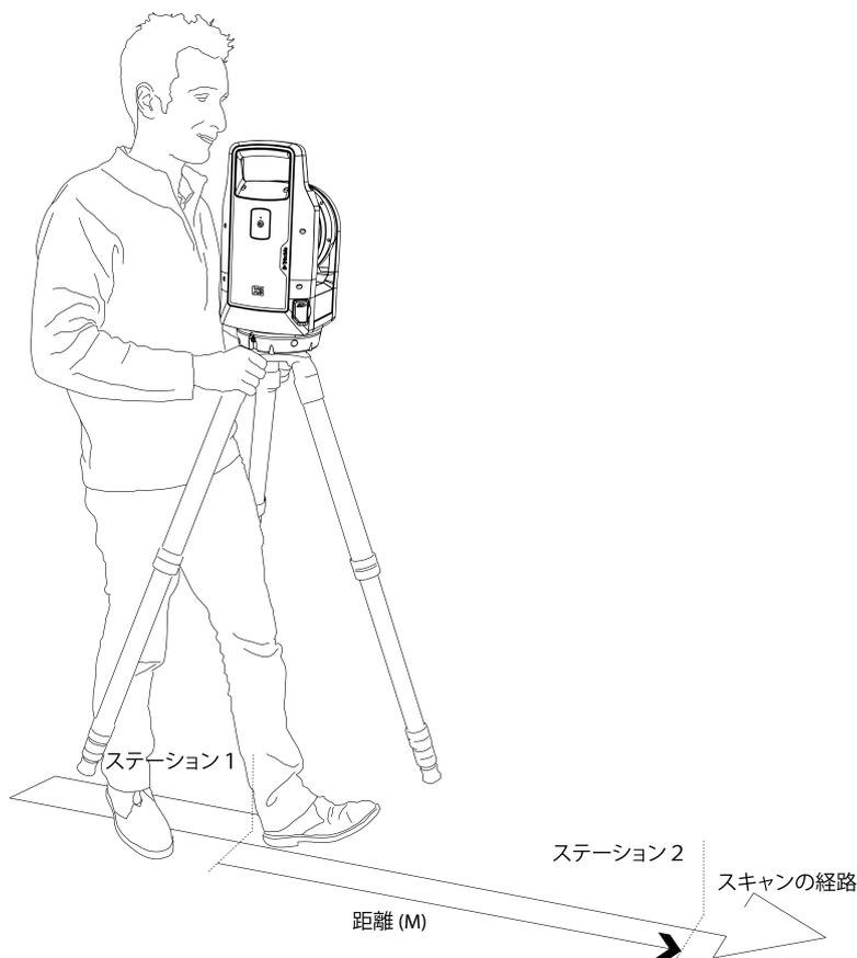
三脚と機器を1つの測点から次の測点に移動します:
