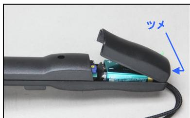
(4) 電池交換や感度変更が終わったら、電池カバーを元通りにセットしてください。
