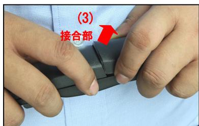
(3) 電池カバーの、本体との接合部を斜め上へ上げ、取り外してください。
