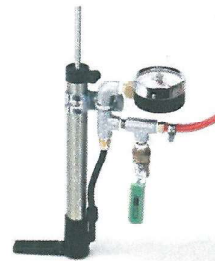
開放弁を開いた状態 (シリンダ内部圧力が上がらない)
