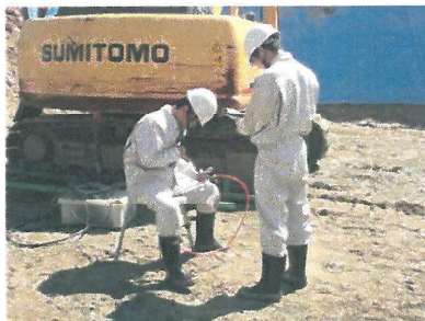
圧力計と変位値の計測結果をデータシートに記載する
