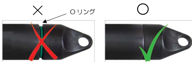
正しい取付キャップの接続
