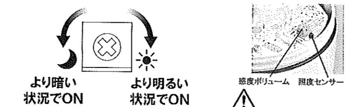
※グローブ自体が外光を多少遮るために、最終確認はグローブを取付けて行ってください。
