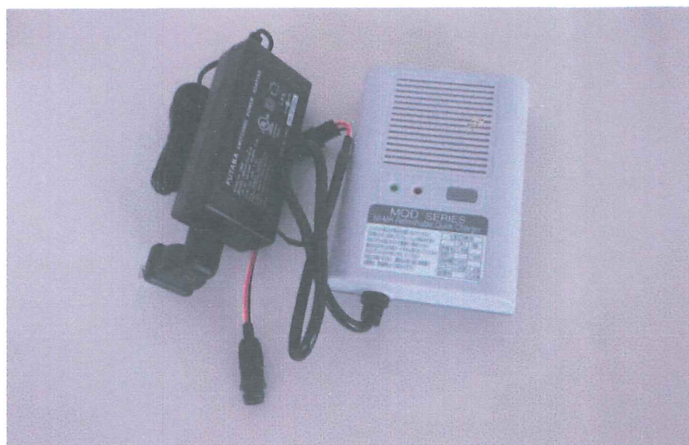
ニッケル水素電池専用充電器 DC24V(オプション) 充電電圧/電流 9~18V 2A
