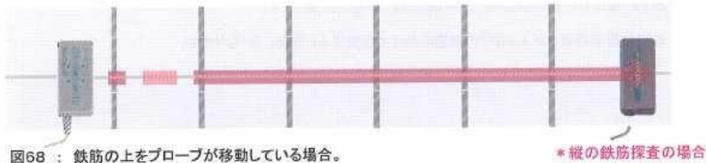
図68 : 鉄筋の上をプローブが移動している場合。
