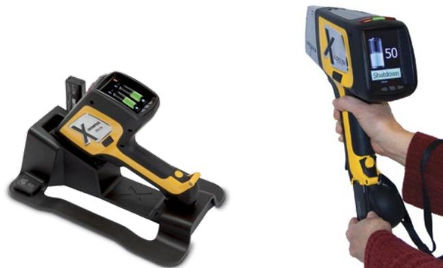
ドッキングステーションは、本体と予備のバッテリーに充電を行い、定期的に装置の状態をチェックします。DELTAは電源を入れたままバッテリー交換ができるホットスワップ機能を搭載しています。
