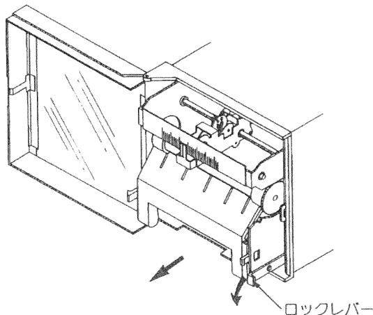
5. インクパッドの突起部をホルダーの溝に合わせて、軽く押し込みます。このとき、左右逆にならないように注意して下さい。
