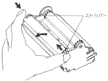
6. チャートカセットの前方部にある記録紙押さえ（透明プラスチック）を手前に倒します。
