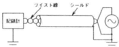
1) 信号源が接地されているときは、信号源に近い方の片隅を接地して下さい。
