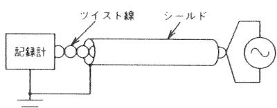
2) 信号源が接地されていないときは、接続機器側で片隅を接地して下さい。
