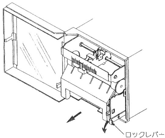
4. チャートカセットの左右端にあるストッパーを内側に軽く押しながら、チャートカセットを本体から取り出します。
