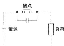
1) 遮断時のアーク除去には非常に効果がありますが、接点開路時、コンデンサに容量がたくわえられるため、接点の投入時にコンデンサの短絡電流が流れますので接点が溶着しやすくなります。
