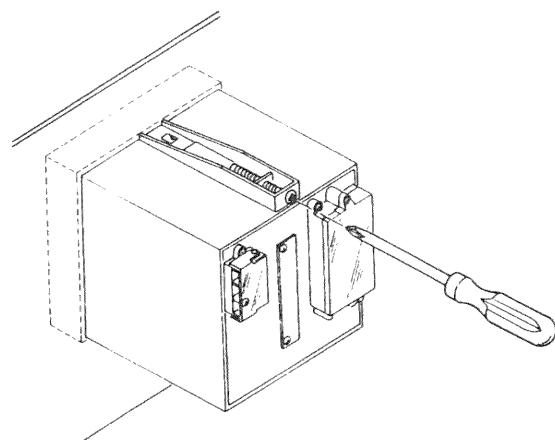
4. パネル取付金具用ネジの適正締め付けトルクは0.5~0.8N.mです。
