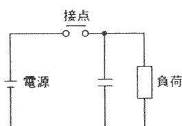
2) 遮断時のアーク除去には非常に効果がありますが、接点の投入時にコンデンサへの充電電流が流れますので接点が溶着しやすくなります。
