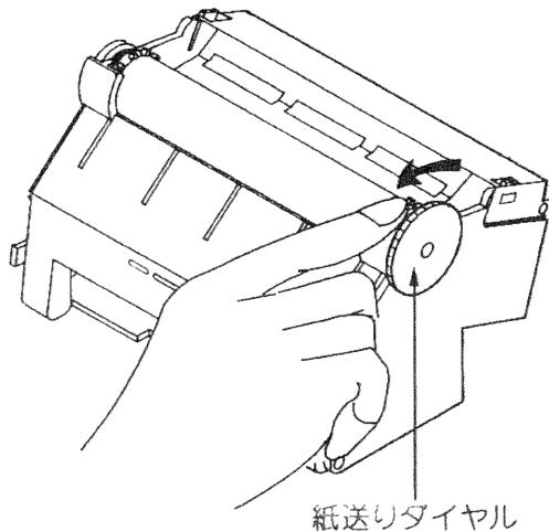
13. チャートカセットの突起部を本体の溝に掛け、カセット全体を本体に押し込みます。この時チャートカセットが確実にロックし、固定されていることを確認して下さい。
