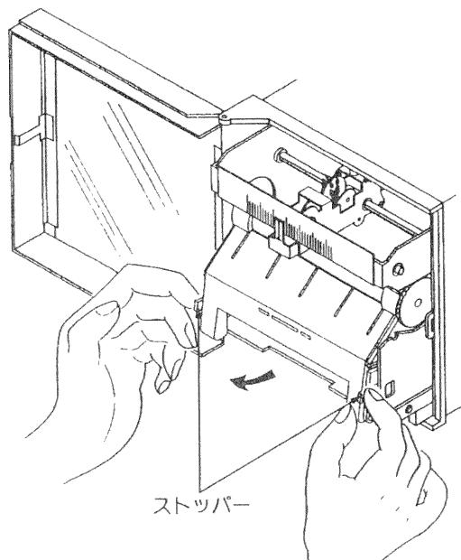
5. チャートカセットの後方左右端にあるストッパーを内側に軽く押しながら、記録紙押さえ金具を持ち上げて開けます。
