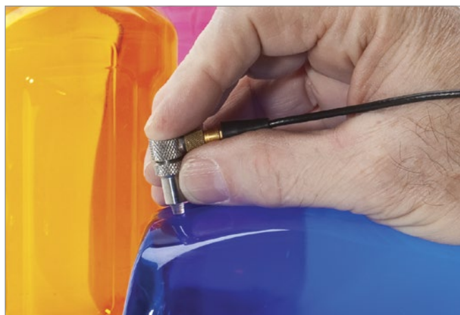
20MHz遅延材付き探触子により薄いプラスチック材を測定
