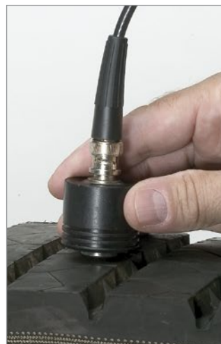
ゴム製ベルトコンベヤー、タイヤのワイヤー層までの厚さ測定
