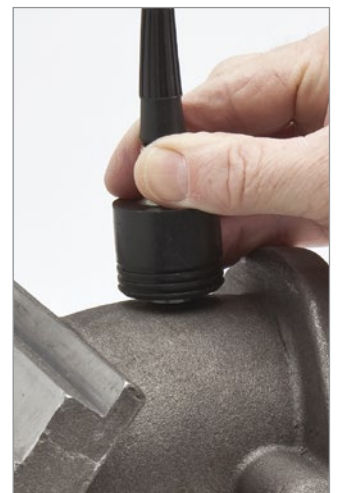
ハイペネトレーション(高浸透)のソフトウエアオプションにより、鋳物などの超音波減衰材料の肉厚測定が可能
