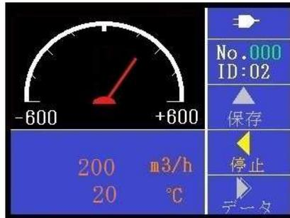
測定中に測定を停止したい場合は[停止]ボタン（
