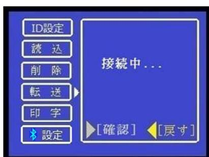
▶で本体と PC との接続を開始します。接続時にエラーが発生した場合は左下図のようなエラー画面が表示されます。
