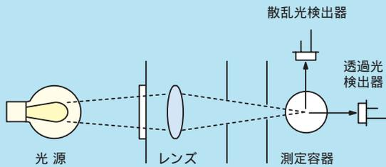
図のように測定容器に光を照射し、透過光と90度散乱光を測定します。
