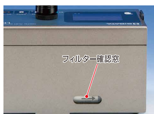
① 確認窓でフィルターの汚れ具合を確認。
