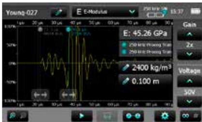
デュアルカーソルモードは自動的に有効になります。最初のカーソルを使用して、P波要素の開始位置をマークします。2番目のカーソルを使用して、S波要素の開始位置をマークします。弾性係数を計算するには、物質の密度を入力する必要があります。PL-Linkへのダウンロード時には、物質のポアソン比も計算されます。
