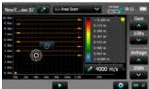
格子上で測定を開始する位置にカーソルをドラッグすることができます。矢印は、測定の進行方向を表します。
