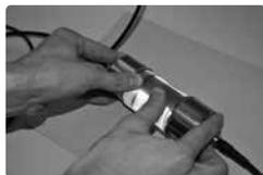
超音波カップラント (E) でトランスデューサを校正ロッド (F) に結合し、両方をしっかり押し込みます。
