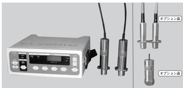
※写真左：測定器本体、中：ひび割れ・音速センサー 写真上右：ひび割れ小型センサー（オプション品） 写真下右：ひび割れ強力センサー（オプション品）
