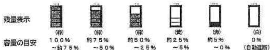
図5.2-4 二次電池容量の残量表示
