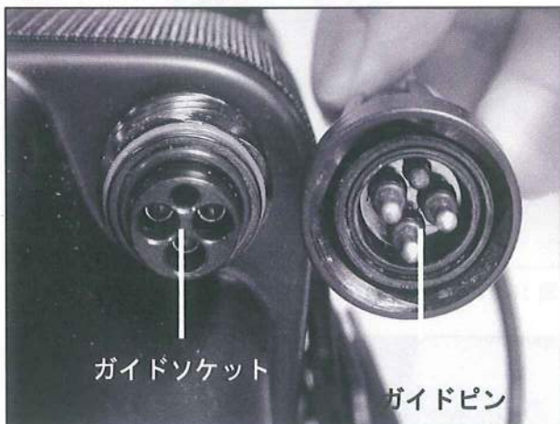
図 13 インターコネクトコードのガイドピン
