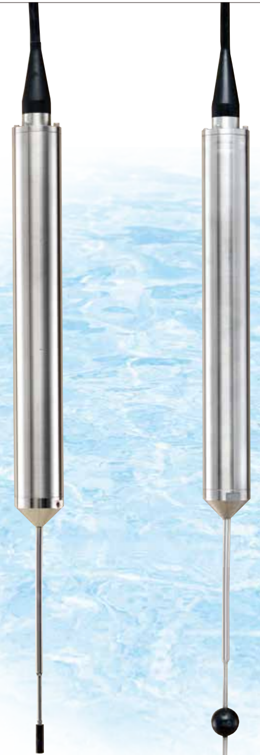
2軸電磁流速センサー ACM2-RS XYデジタル出力 センサー直径6mm
