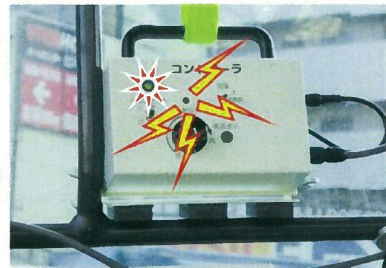
コントローラ <音と光(LED)で警報>
