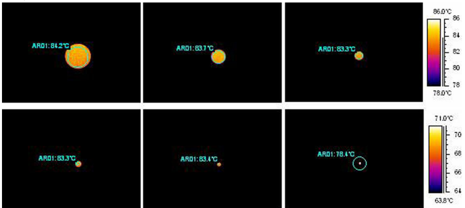
図 17.20 距離を遠ざけながら +85°C 黒体から読み取った温度 (24 レンズ)
