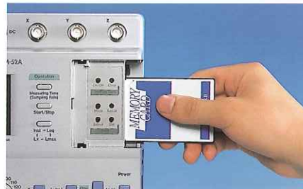
VM-52Aパネル内カード挿入口
