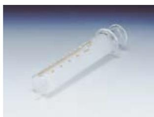
瞬間値の測定あるいは高温ガス、高濃度ガスを測定する場合に使用します。内容量は100mLと200mLがあります。
