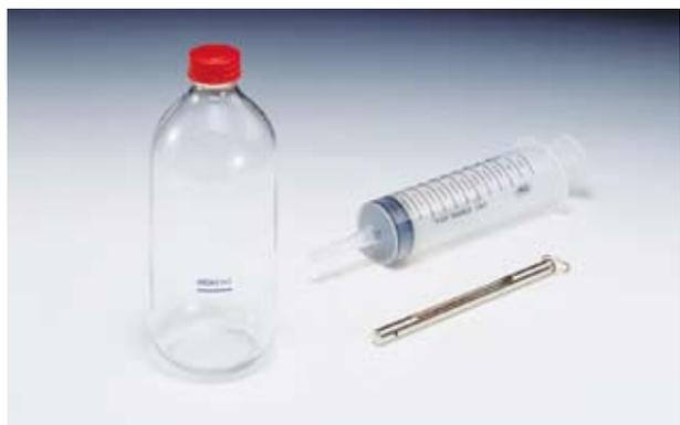
クリーニングや半導体部品洗浄等の産業に使用される塩素系有機溶剤による公共用水や地下水の汚染が問題となっており、地下浸透禁止などの規制を強化するため、水質汚濁防止法および下水道施行令の一部が改正されました。P-20およびP-24APは、ヘッドスペースガスを検知管で測定することにより、排水中の溶剤濃度を簡単に測定できます。
