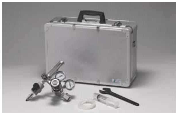
呼吸器用圧縮空気中に不純物が含まれると人体に影響を与えます。P-40Rは、ポンベの中の圧縮空気を専用減圧弁を用いて検知管に通気する事により、圧縮空気中の不純物を簡単に測定することができます。
