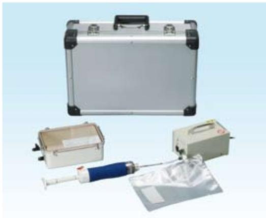
VOCを触媒で酸化分解し、二酸化炭素濃度として測定するので公的測定法に準じた炭素換算濃度が得られます。
