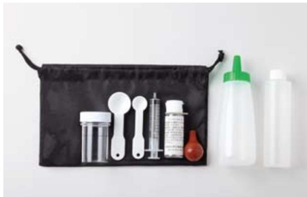
塩害を受けた土壤の塩分をメンテナンス、校正が不要、低価格で簡単に測定することができます。
