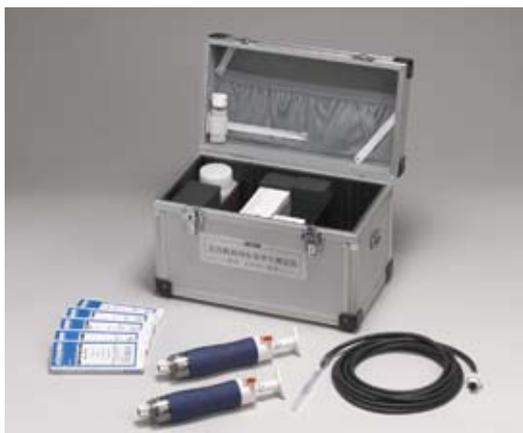
突然発生する様々な災害において、救助活動をする人たちの二次災害も少なくありません。中でも有害ガスによる災害は、目に見えないため非常に危険です。災害救助用有害ガス測定セットは、救助現場で簡単に、また迅速に有害ガスを測定するために必要な器具をセットしております。
