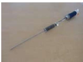
ガス採取器の取付ネジを取り外し、取付口ゴム管を差し込んだ状態でホルダーを接続します。検知管の両端をカットしてプローブに接続し、固定つまみを開いてから検知管をホルダに挿入します。検知管を取付口ゴム管に差し込みます。最後に固定つまみを締め込みます。
