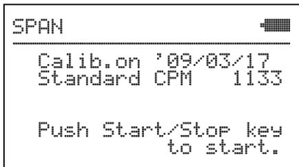
感度調整を行います。感度調整を行う前に、かならずバックグラウンドの調整を行ってください。バックグラウンドの調整後、感度チェックつまみを”FULL”側に合わせます。
