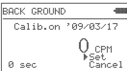
測定が終わると、その時点でのバックグラウンドの平均値(CPM)が表示されます。
