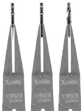
Fig. 16: この写真はピン交換に際して、プライヤーのどの部分で挟むかを示しています。（プライヤーの先端部で、ピンを挟んでください）
