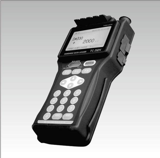
TC-32Kは片手にすっきり収まるコンパクトな形状のハンドヘルドタイプの測定器です。防滴構造を採用していますので、屋外でも安心して使用できます。センサを接続する端子部は、リード線、バナナプラグとも簡単に接続可能なワンタッチタイプ(特許)を採用し、スピーディに測定ができます。最大20チャンネルのセンサモード、係数、イニシャル値の設定と測定データの記録が可能で、複数の現場を移動しながらデータを収集する場合などでもデータ整理が容易です。また、専用スイッチボックスCSW-5Bを使用することにより5点の自動計測が可能です。インターバルタイマ、データメモリ、さらにはCFカードによる記録や、パソコンと接続してコントロールやデータ転送も行えます。抵抗および絶縁抵抗のチェック機能により、ひずみゲージや変換器などのチェックにも使用できます。
