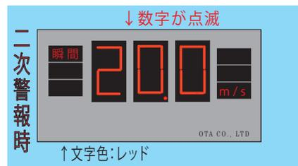
従来の風向/風速/雨量の測定において、当社では離れた場所からでも視認できる大型表示板を製作しました。風速計や雨量計を接続し、100m程度離れた場所からでも視認できる大型表示板です。外装はステンレスを使用し、堅牢な仕上がりになっています。また、重量が約12kgなので設置や運搬が容易に出来るように仕上げております。風速や雨量の警報設定値と連動し、警報発令時には数値の点滅や、項目値(「瞬間」「平均」「雨量」等)の文字色が変化し、警報の度合(1次警報・2次警報)がわかるように作られています。メーター部との接続はRS-485 (LANケーブルを使用。OT-920)・RS-232C (OT-901/OT-708/OT-511)でつなぐだけ。簡単です。※1
