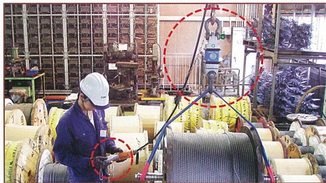
●天井クレーンの安全確認
