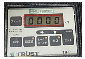
V 「1100」の「11」はTR荷重計と接続したとき、00の場合は、自動的に設定が読み込まれますが、「11」の場合は自動的に設定を読み込むことを禁止するため、TRを使用される場合は必ず「0000」にしなければなりません。
