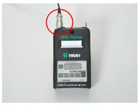
デジタルプリンター付表示機の 入力コネクタにセンターホール型 荷重計が接続されていることを 確認します。
