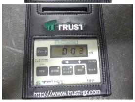
VII 一度電源を落として、再度起動させると、 表示は接続している荷重計の 画面になります。
