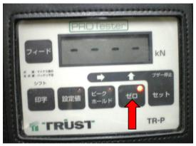
⑦ [ゼロ]ボタンを押し、ゼロ設定をします。表示部に「---」表示後、通常表示に戻ります。[ゼロ]ボタンのランプが点灯します。
