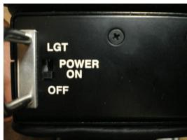
② 電源スイッチを[POWER ON]の位置に合わせます。※バックライト使用時は「LGT」
