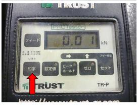
(i) [印字]ボタンを押し、測定データを プリントします。
