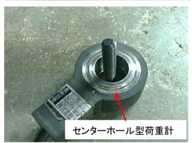
③ 凸型の出っ張りに収まる様に センターホール型荷重計を設置します。
