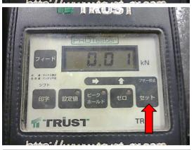
⑤ 点滅している数字に対して[ピークホールド]ボタンで右の桁に移動、[ゼロ]ボタンで数字が増加します。
