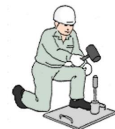
②打込棒の打込み
