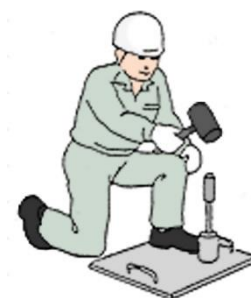
② 打込棒の打込み
