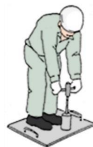
③打込棒の引抜き
