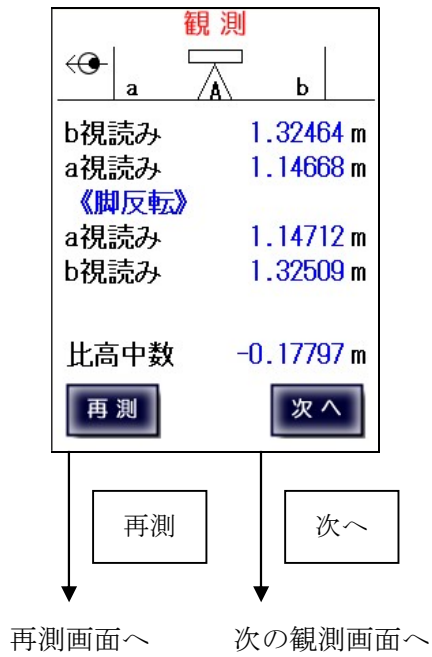
傾けた整準状態での観測結果表示画面
