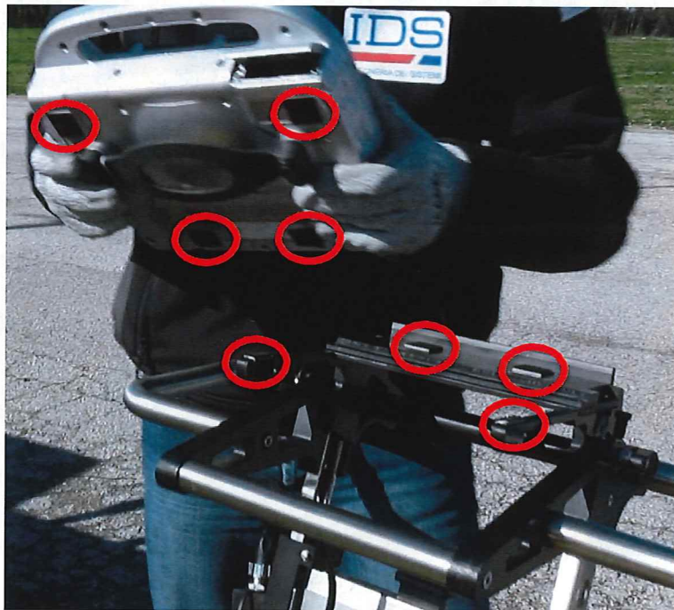
Fig. 4.6 – ラップトップとラップトップ・サポート上の VELCRO ストリップ
