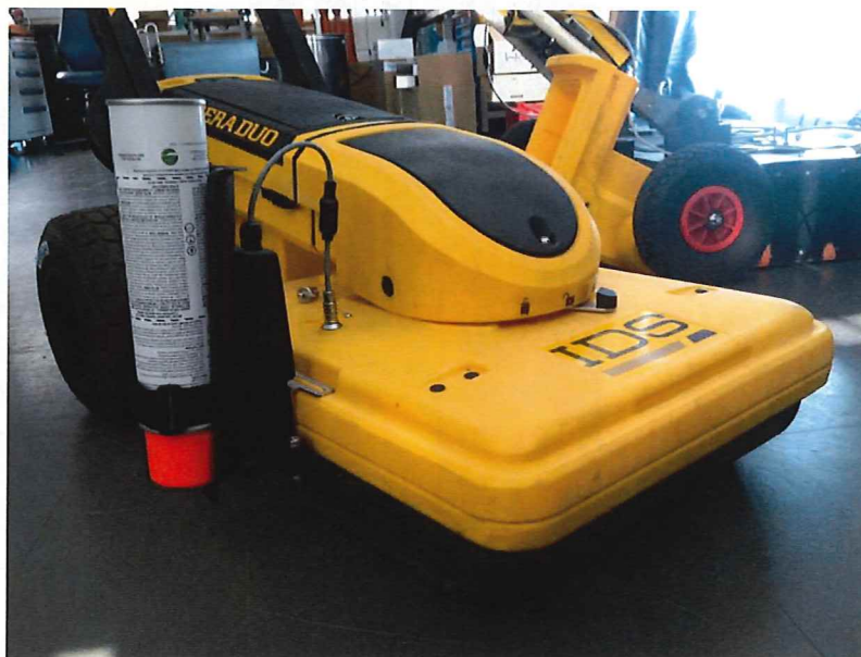
Fig. 4.11 – マーキングスプレーの固定
