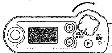
②ヘッドセットのスピーカーから音が出ていないときは、[MONI]キーを押します。「ザー」という音が聞こえます。この音を聞きながら、電源・音量ツマミを回し音量を調整してください。
