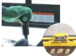
前・後進の切り替えの際、切り替えレバーに連動して自動的にモニター表示が切り替わります。
