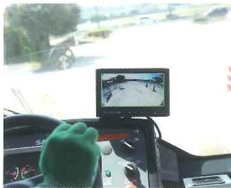
検知範囲内に人（歩行者・作業員）が入った場合、キャビン内のモニターにアラート（警告）が表示され、同時に警告灯が作動し、オペレーターに危険を知らせます。
