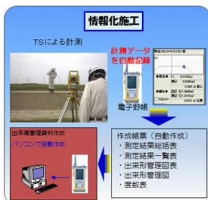
**情報化施工**ではトータルステーションとプリズムを使って測量した結果を電子野帳に取り込んで、そのデータを事務所のパソコンにつなげることによって、出来形管理表や出来形管理図を**自動**作成することができます。この電子野帳が【13 測量機 データコレクタ SHC250 モバイルデクスパートLan Deco (カタログp241,242)】になります。電子野帳とつなげることが可能なトータルステーションが必要となり、また出来形管理表や出来形管理図を作成するには専用のソフト（“建設システムのデクスパート”や“福井コンピュータの武蔵”など）がいろいろあります。
