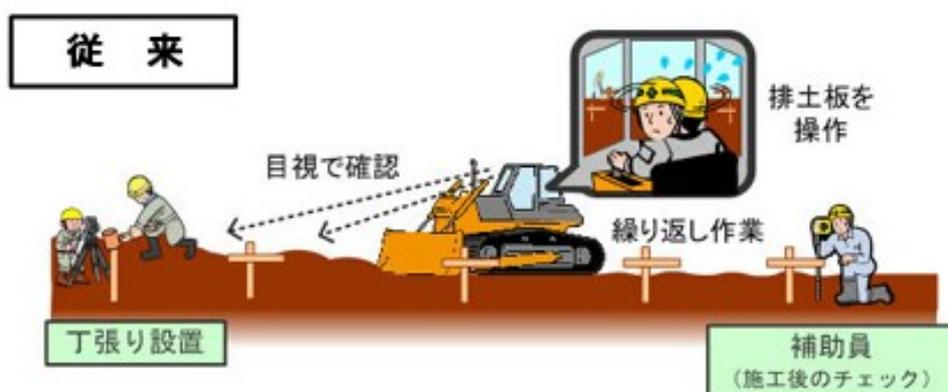
**情報化施工**では、あらかじめ設計データ（仕上げる高さのデータ）を重機に取り込んでおいて、重機に取り付けた受光器の高さをトータルステーションが読み、そのデータを重機に送り、その情報から現在の重機の位置や排土板の高さを計算します。その計算結果を基に重機や排土板の位置をモニターに表示したり、重機を**自動制御**（運転手が操作すること無しに勝手に重機が動く）することができます。
